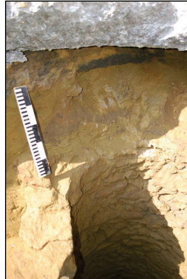
FIG. 24 Het profiel net onder het betonwegdek.
