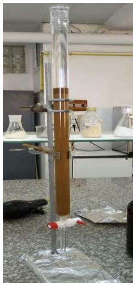
Figure 28 : chromatographie sur colonne de polyamide de la fraction F1-4.
