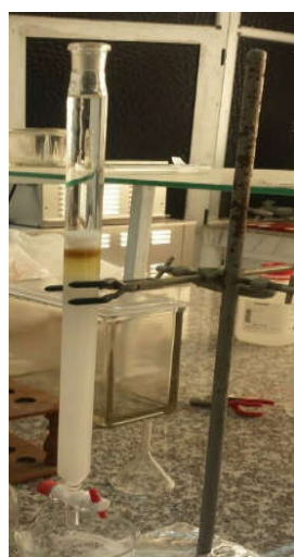
Figure 29 : chromatographie sur colonne de gel de silice de la sous fraction F18.
